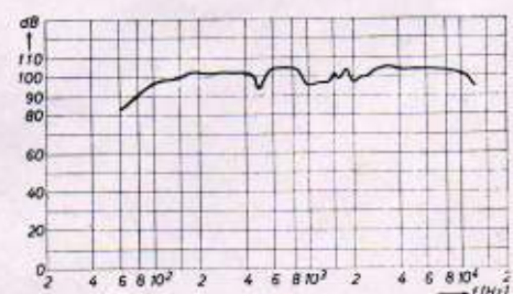
Abb. 27. Frequenzgang des Breitstrahler-Lautsprechers, gemessen mit 1 Va in 1 m Abstand
