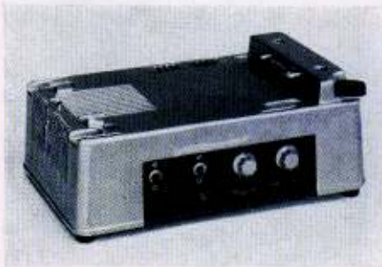
Abb. 16. Vorverstärker für Rundfunkgeräte.
