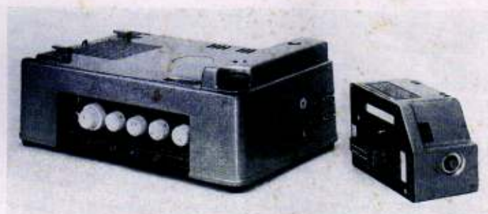
Abb. 16. Vorverstärker für Rundfunkgeräte.
