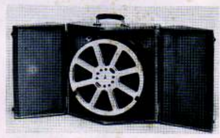
Abb. 22. Lautsprecherkoffer, ausgestattet mit permanentdynamischem 15-Watt-System
