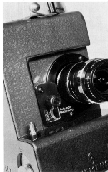
Umschaltung der verstellbaren Sektorenblende
