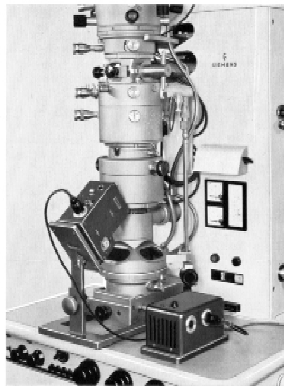
Elektronenmikroskop, Typ Elmiskop I, mit angebautes Registriergerät und dem dazugehörigen Netzgerät
