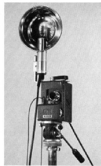
Siemens-Registriergerät Modell A, aufnahmebereit mit Elektronenblitz
