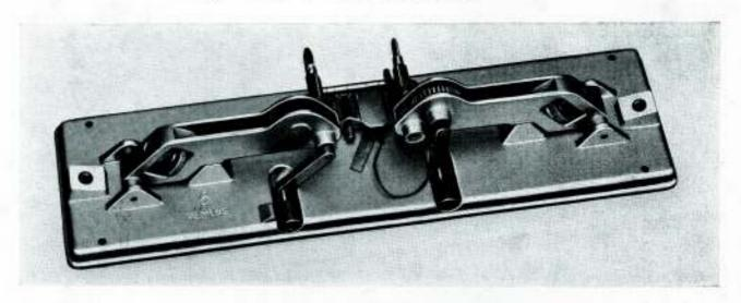
Der Siemens-Umroller für 16-mm-Schmalfilm ist ein stabiles handliches Gerät aus Silumin, mit den Abmessungen 43x12x8 cm. Er nimmt, zusammengelegt, nur einen kleinen Raum ein und ist aufgeklappt für 120-m- und 240-m-Spulen verwendbar. Mit den beiden Rändelschrauben sind die Spulenträger in Ruhe- und Arbeitsstellung fest verschraubbar, so daß der Umroller in jeder Lage ein einheitliches Ganzes bildet und kein Lockerwerden irgendeines Teiles zu befürchten ist.
