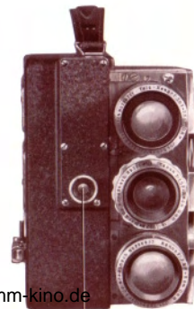
Objektivöffnung des Durchsichtsuchers
