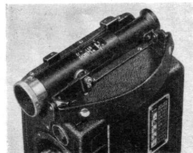
Multifokalsucher der Siemens-Kino-Kamera F II
