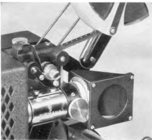
Bild 3. Siemens-Umkehrprisma; Befestigung am Siemens-Standard- Projektor bzw. Siemens-Projektor 375
