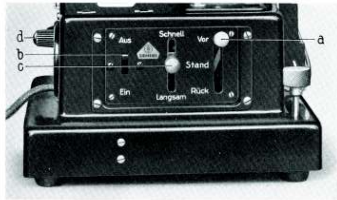
Bild 7. Sockel mit Schaltplatte.
