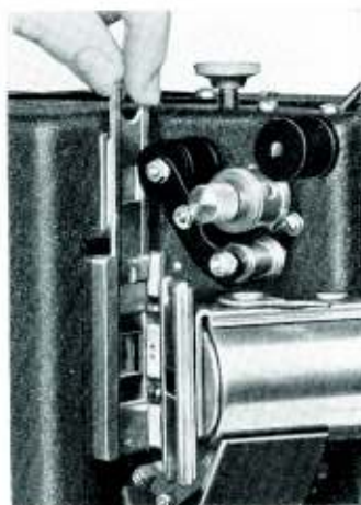
Bild 17. Herausnehmen der Einlage mit Stahlkufen aus dem Filmkanal.
