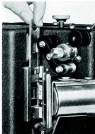
Bild 15. Herausnehmen der Einlage mit Stahlkufen aus dem Filmkanal.
