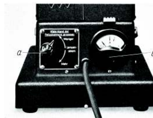
Bild 7. Sockel mit Widerstandsrehknopf und Strommesser.
