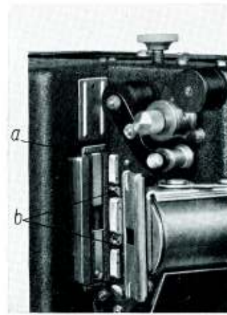
Bild 16. Einlage mit Samtkufen in den Filmkanal eingesetzt. a = Hier Schraubenzieher ansetzen b = Führungsrollen
