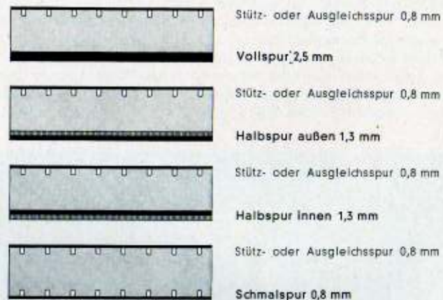
Bild 2: Magnettonspuren auf 16-mm-Schmalfilm
