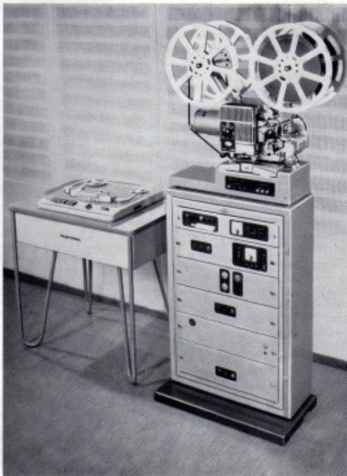
Bild 6: Tonwege-Schaltgerät in der Tischplatte des Zweibandprojektors
