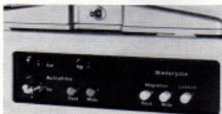
Bild 6: Tonwege-Schaltgerät in der Tischplatte des Zweibandprojektors
