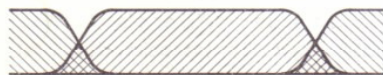
3. Teilweise Neuvertonung einer vorhandenen Aufnahme. Übergang beim Ein- und Ausblenden stufenlos regelbar.
